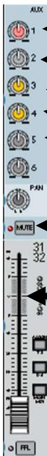
IL potenziometro AUX 1 indica la regolazione del volume del monitor (cassa spia) ALTO
